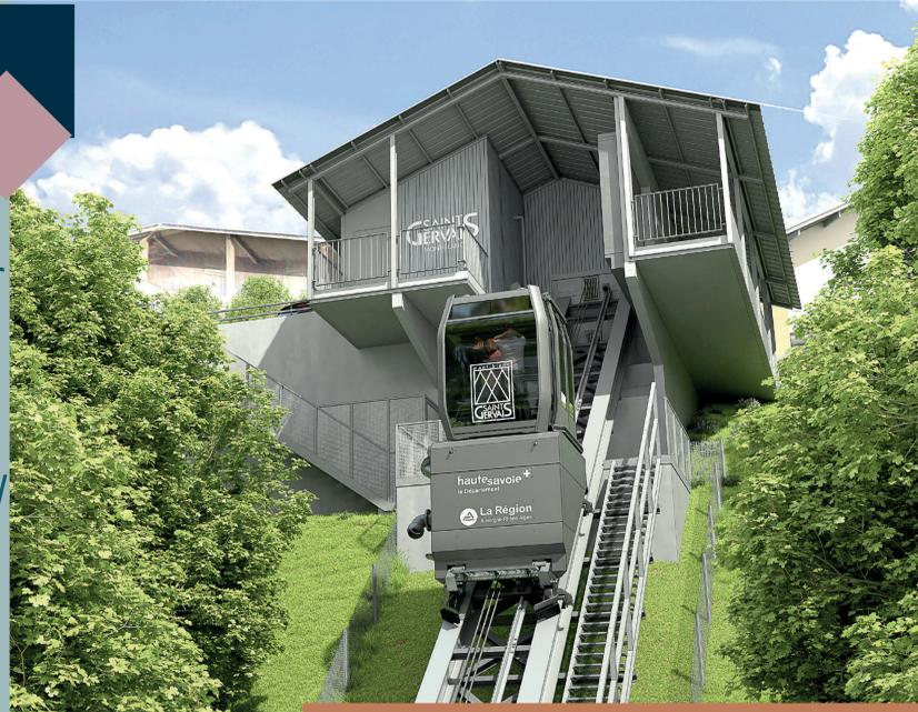
Au cœur de ce projet réside une **INGÉIEUSE INNOVATION** : **L'EXPLOITATION DES EAUX USÉES POUR LESTER LE VÉHICULE.** Les eaux usées sont déviées du réseau communal et stockées en amont vers un réservoir en béton de 20 m<sup>3</sup>. Pendant que le véhicule effectue un cycle d'aller-retour, les eaux sont pompées vers un réservoir de gavage de 1 200 litres profitant de **L'ÉNERGIE PRODUITE PAR LA FORCE GRAVITAIRE** du véhicule descendant.
